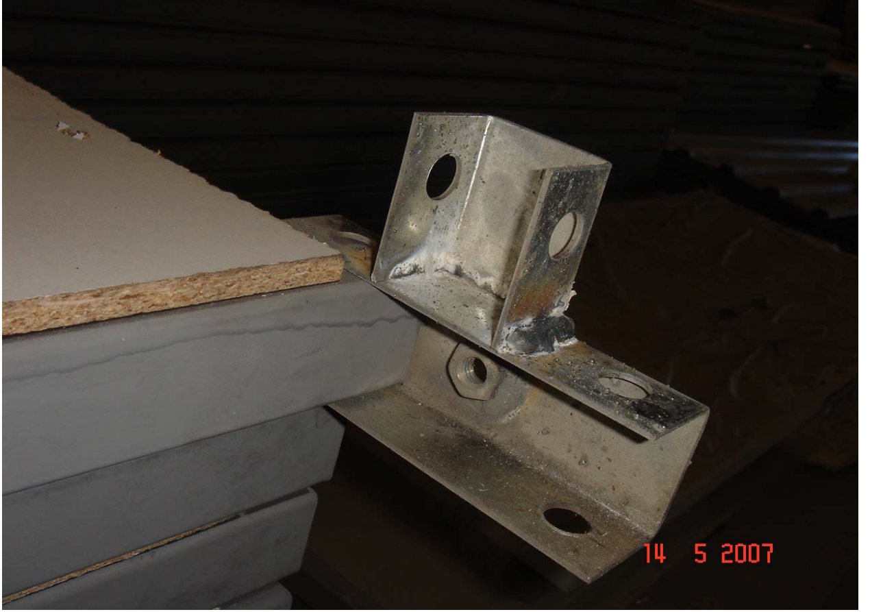
Resim 5 - Üçlü Kep Görüntüsü ve Cıvata Yerleri
